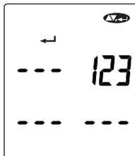
左图所显示的是安全密码设置页面，图中所显示的123数字是仪器原先设定的密码。如果不需要任何改变，按[▲]键前进至LEL标准气模式。如果需要更改密码，按[←]键，此时安全密码的第一个数值会闪烁，按[▼]和[▲]键更改第一位数字，更改完成后按[←]键确认，确认后跳到下一位数值，用同样的方法更改后两位数字。设置完成后屏幕上会以
