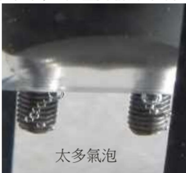
5. 輕搖晃浸入溶液中的儀器，可幫助獲得一個較精確的測量值。幾秒鐘後，儀器的溫度讀值和溶液的溫度將會一致。
