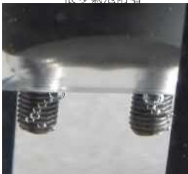
減少氣泡的放法: 短暫的將電極浸潤入溶液中，並拿出甩掉氣泡。
