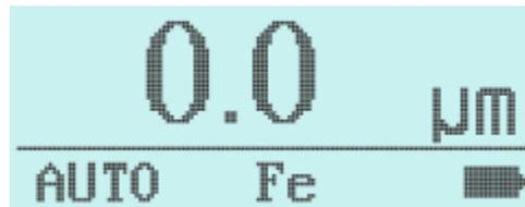
3.5 调零完成后，将标有标准数值的测试片放在调零板或基体上测量，如果数值稳定且与标准片上标定的数值一致（误差在 $\pm 1 \mu\text{m}$ 内），说明仪器可以正常使用了。
